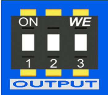
Şekil 14. Çıkış Sinyali (Feedback) Seçim Sivici
