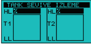
Şekil 16. Tank seviye izleme ekranı
